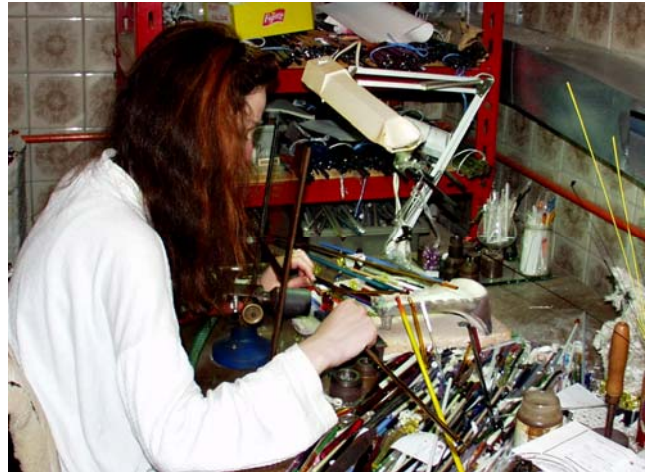
Gestalten von kleinen Figuren aus Glasstängeln vor dem Gasbrenner
