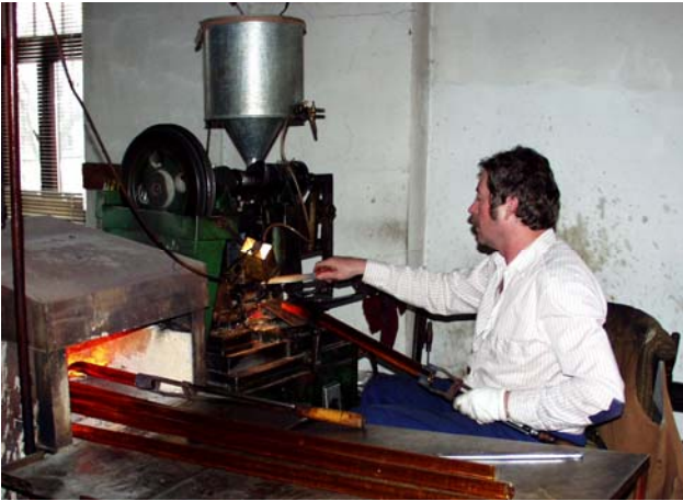
Knopfdrücker in der Nähe von Jablonec nad Nisou (Gablonz an der Neiße) an einer halbautomatischen Knopfpresse
